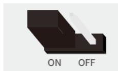
图2（已连接匹配电阻）
