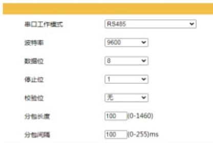
串口参数配置与ModbusSlave软件配置示例
