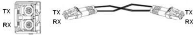
图 9 千兆SFP 光模块接线图
