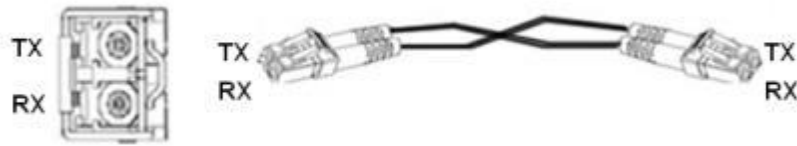
图 9 千兆SFP 光模块接线图
