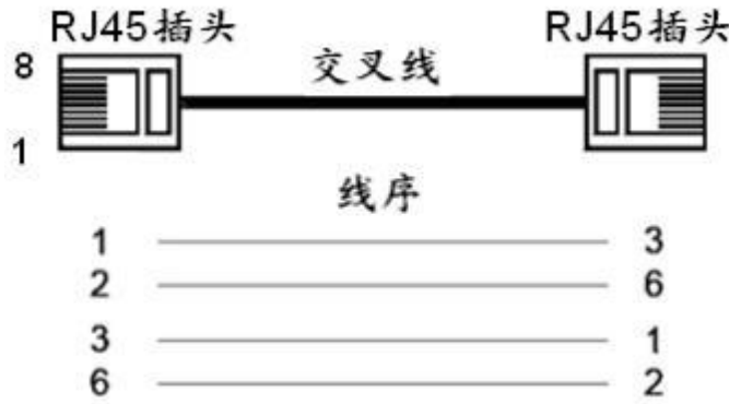
图 12 10/100Base-T(X) RJ45 插头交叉线互连
