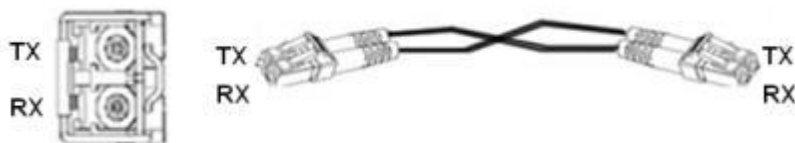
图 9 千兆SFP 光模块接线图
