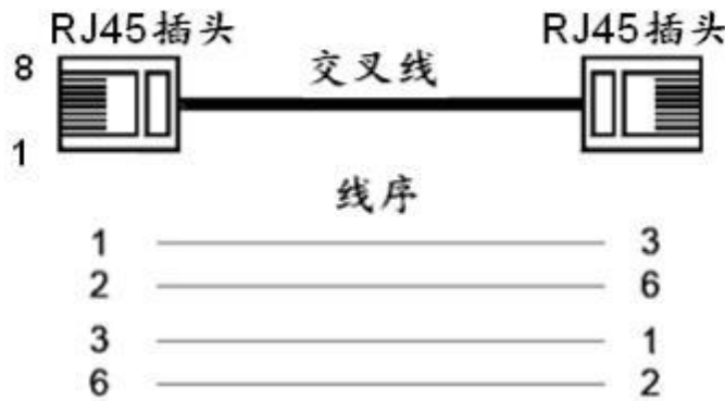
图 12 10/100Base-T(X) RJ45 插头交叉线互连
